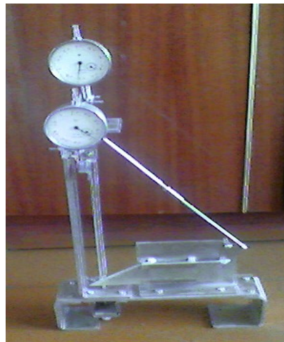
Рис. 1. Стенд для випробування опори протяжних споруд для основ, які деформуються.
